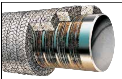
Problem: Standard Packung verglast und beschädigt die Welle
